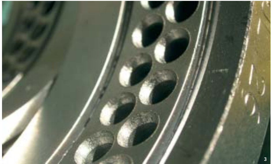
3 Ringmatrize der Laborpelletspresse der HFA
