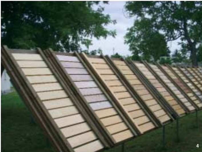
4 Freiluft-Bewitterungsstand für farblose Beschichtungssysteme im Projekt „Brightwood“
